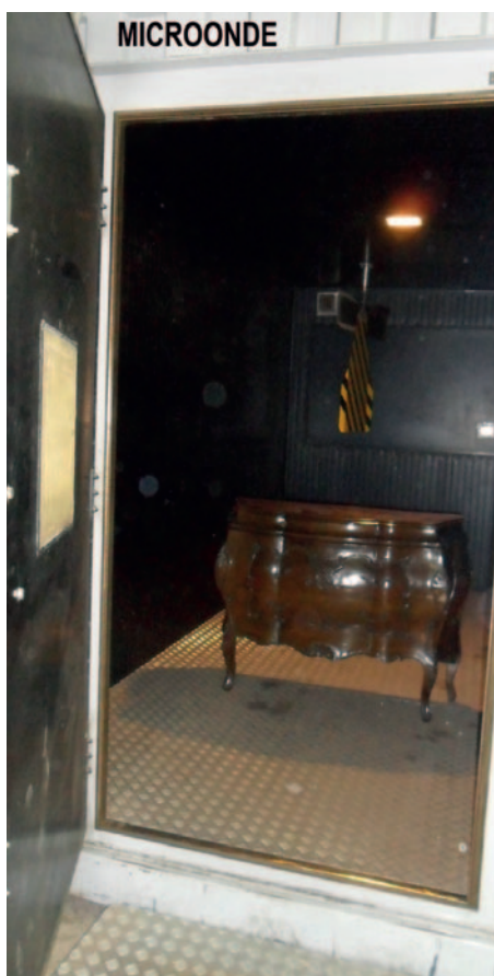
Mobili disinfestati con microonde
