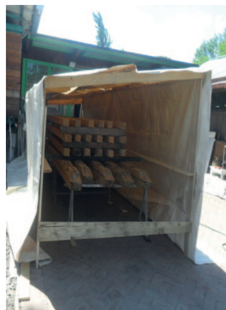
Travi disinfestate con calore
