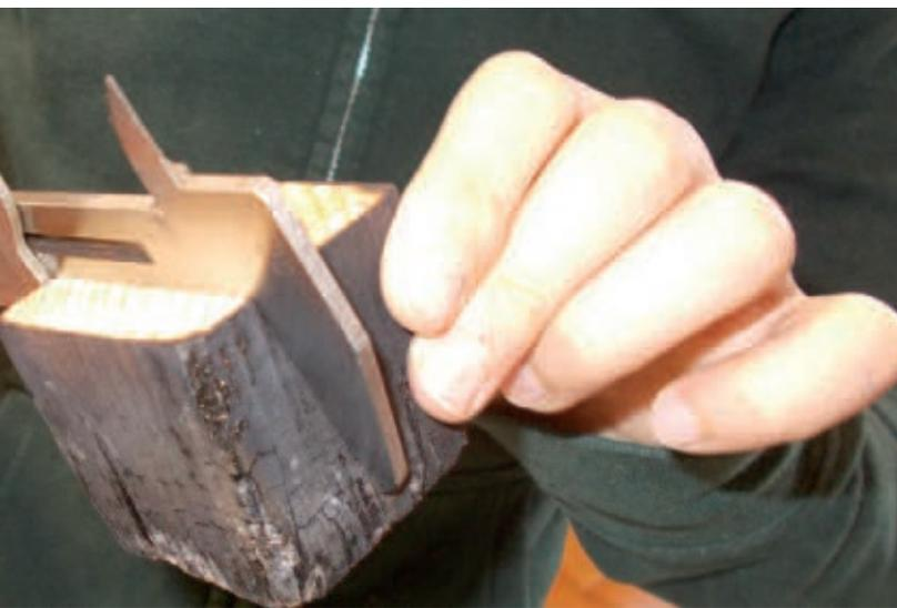
La **prova di imbibizione** si è svolta nel seguente modo: tre gruppi hanno immerso i cubetti con fibratura orizzontale; tre gruppi, invece, hanno immerso i cubetti con fibratura verticale. La profondità di immersione è stata di venti millimetri, ovvero metà dell'altezza.
