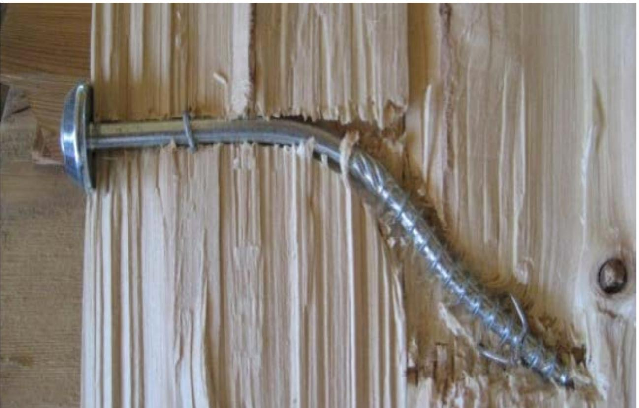
Vite di collegamento che assorbe l'urto deformandosi senza rottura
